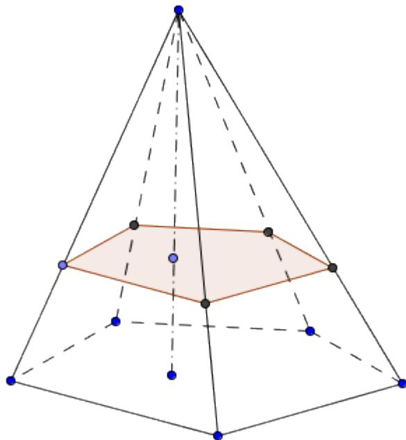
*La section d'une pyramide par un plan parallèle à la base est **une figure qui est une réduction de la base, d'un rapport donné par Thalès.** Ses côtés sont parallèles à ceux de la base.*
