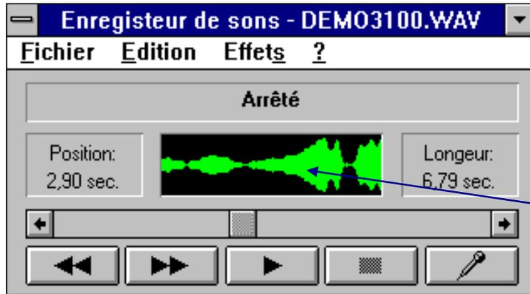
L'enregistrement au micro d'une voix humaine à l'aide de l'enregistreur de sons de Windows : un exemple de signal analogique.
